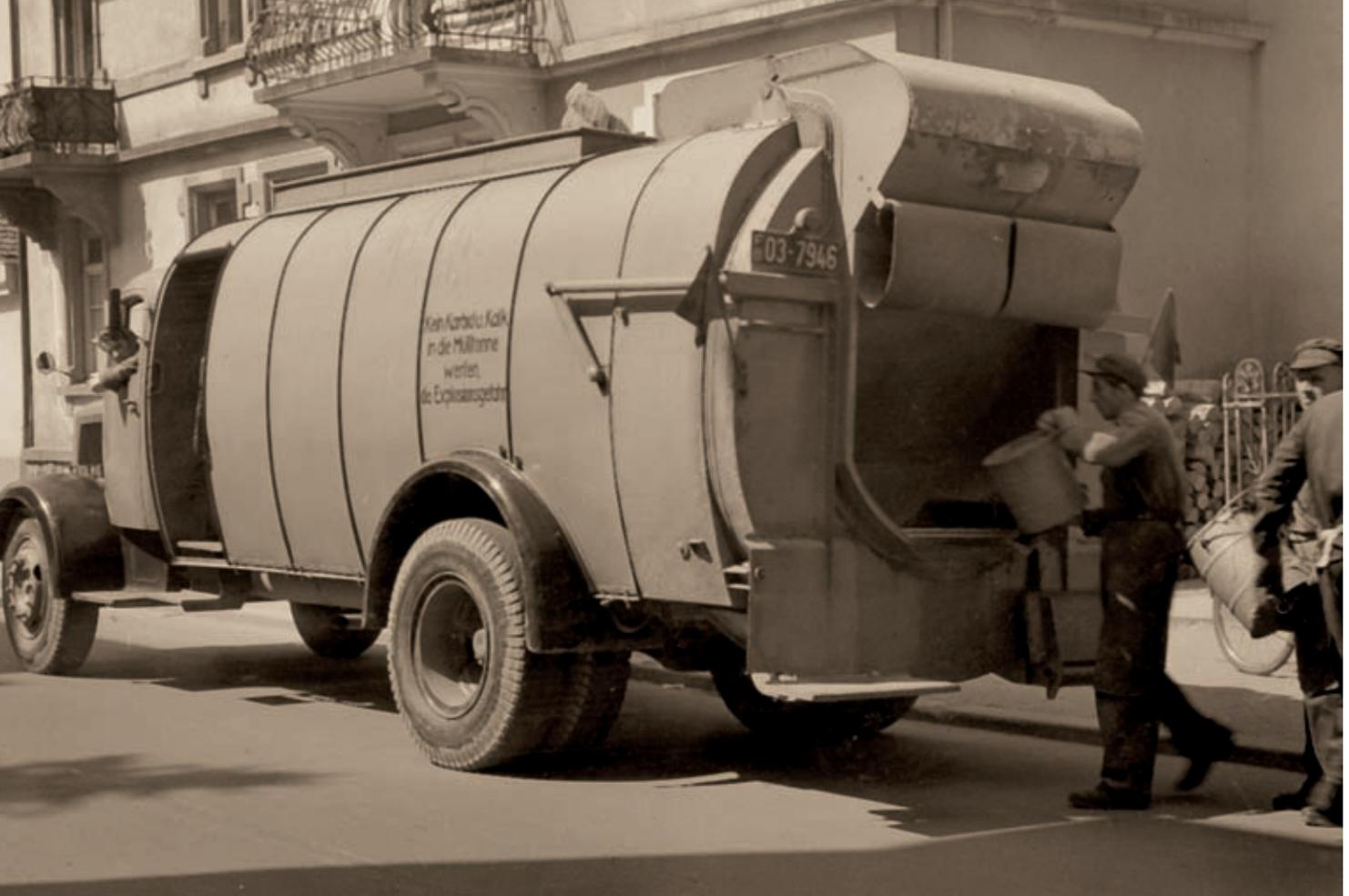
Müllwagen 1952 mit Schüttungssystem (Kuka)
